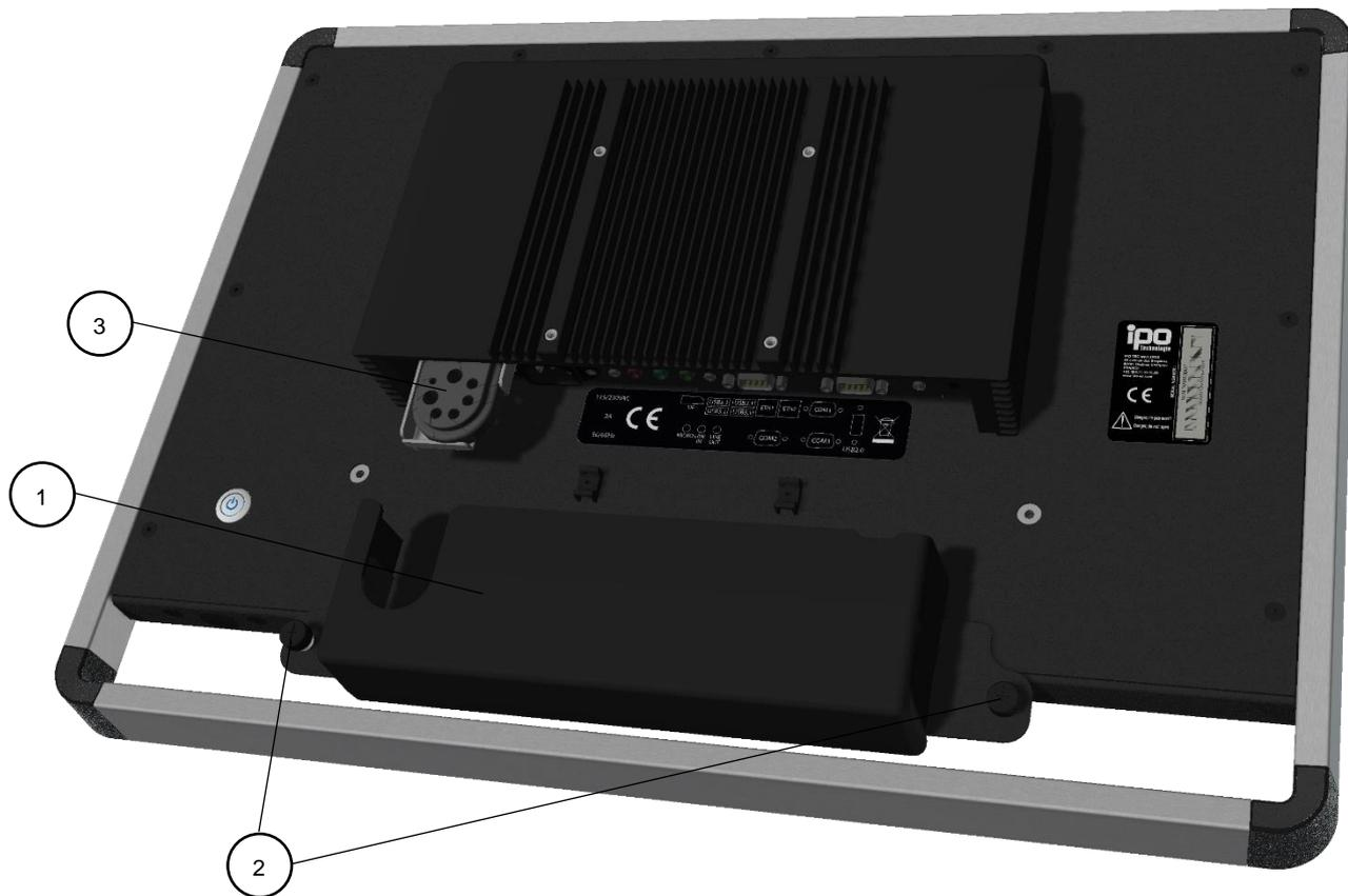
Passer les câbles par le joint multicâbles **rep.3**. Remettre en place le cache câbles **rep.1** et visser les deux vis imperdables **rep.2**.
