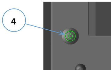
L'appareil est par défaut configuré pour démarrer dès qu'il est mis sous tension (auto-power ON).
